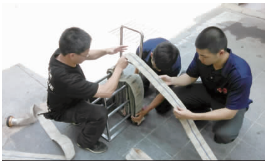
金城消防分隊小隊長研發水帶架，縮短火災現場佈線時間。(金城消防分隊提供)
