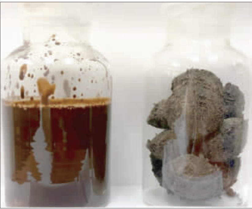
中華醫事科技大學透過產學合作計畫進行技術研發，成功將原是廢棄物的生質油水混合物（左）轉質成可部分取代煤炭的衍生性燃料（右），降低煤炭使用量。（中央社）
