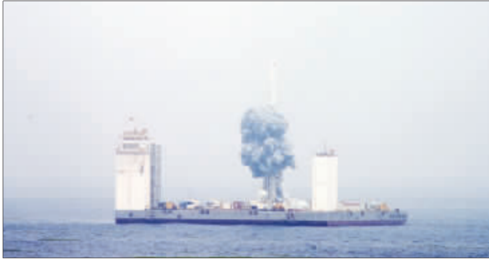
中國使用長征11號運載火箭在黃海海域成功完成「一箭七星」發射試驗，是中國首次的海上航太發射。分析指出，在海上發射運載火箭的優勢是可自由選擇發射海域。（中央社）
