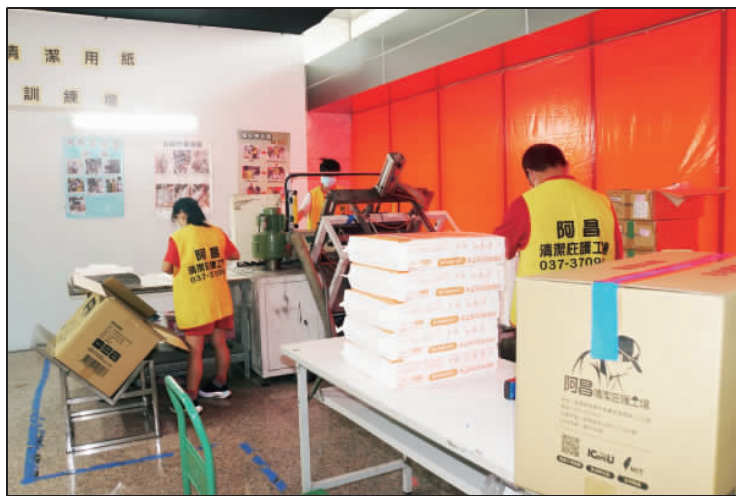
阿昌清潔底護工場的工作情況，一人從大紙箱中拿出衛生紙，裝進8包裝塑膠袋中，另一人再用機台封口，最後經品管檢查合格，才能裝進紙箱搬上棧板出貨。（中央社）
