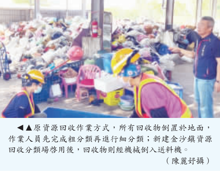
▲▲原資源回收作業方式，所有回收物倒置於地面，作業人員先完成粗分類再進行細分類；新建金沙鎮資源回收分類場啟用後，回收物則經機械倒入送料機。（陳麗好攝）
