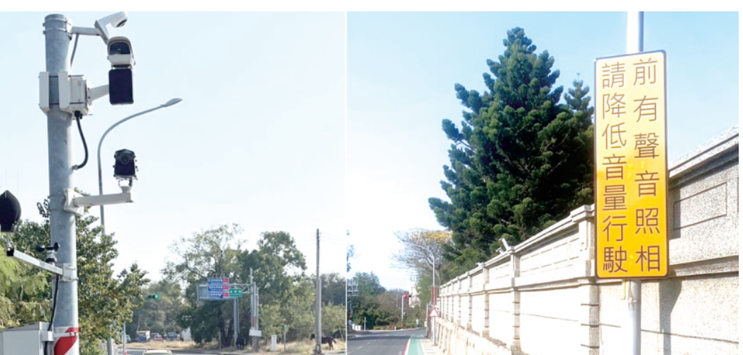
環保局在金城鎮光前路(金城坑道金門高中出口前路段)增設固定式聲音照相系統。(環保局提供)
