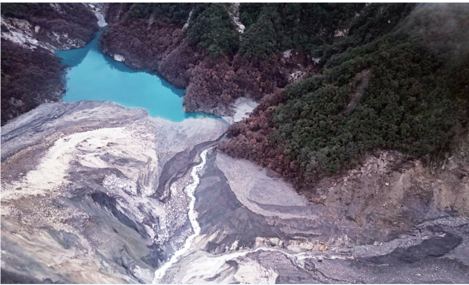
林業及自然保育分署花蓮分署持續監測馬太鞍溪堰塞湖狀況，蓄水量維持150萬噸，穩定從溢流口流出，下游800公尺處小型堰塞湖23日溢流後，小湖已經消失，河道流路恢復正常。
